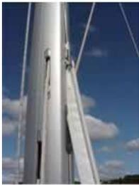
T-5 モデルのマストラックは PVC 製のフレキシブルな物で、容易にマストに取り付けられます。
